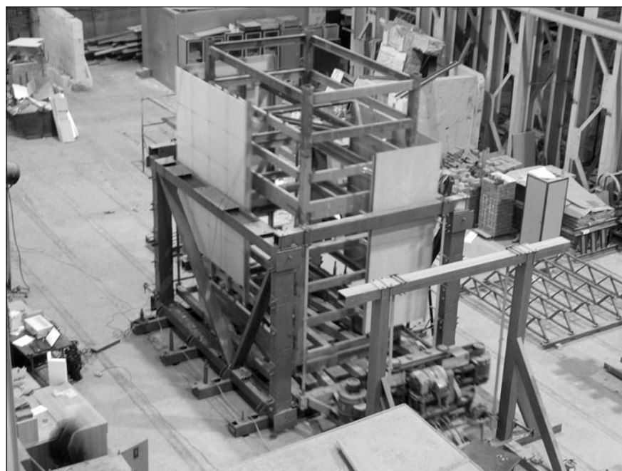
Рис. 2. Общий вид виброплатформы с установленным на ней стендом
